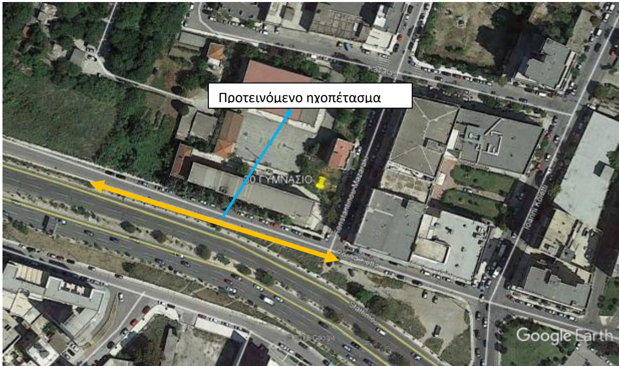
Σχήμα 19: Προτεινόμενο αντιθορυβικό πέτασμα στο 4ο Ειδικό Δημοτικό & 30ο Γυμνάσιο μήκους 120 μέτρων και ύψους 4 μέτρων
