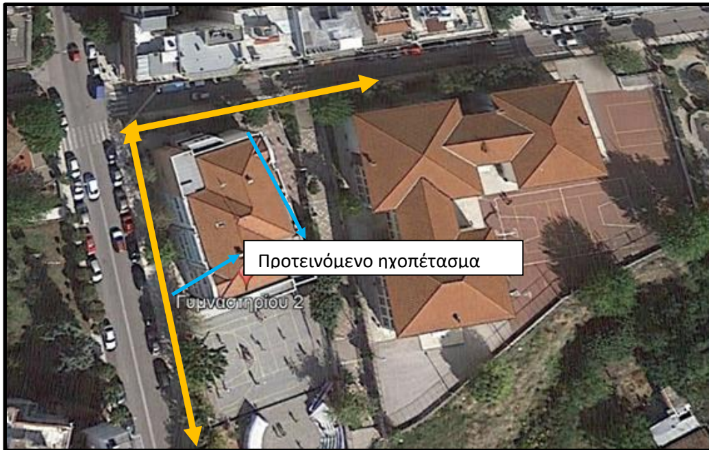
Σχήμα 28: Προτεινόμενο αντιθορυβικό πέτασμα στο 1ο Δημοτικό Τριανδρίας μήκους 86 μέτρων και ύψους 4 μέτρων
