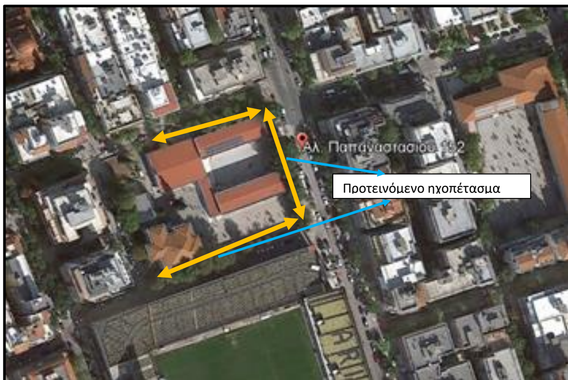
Σχήμα 32: Προτεινόμενο αντιθορυβικό πέτασμα 15 ο Δημοτικό & 76 ο / 99 ο Νηπιαγωγείο συνολικού μήκους 225 μέτρων και ύψους 4 μέτρων
