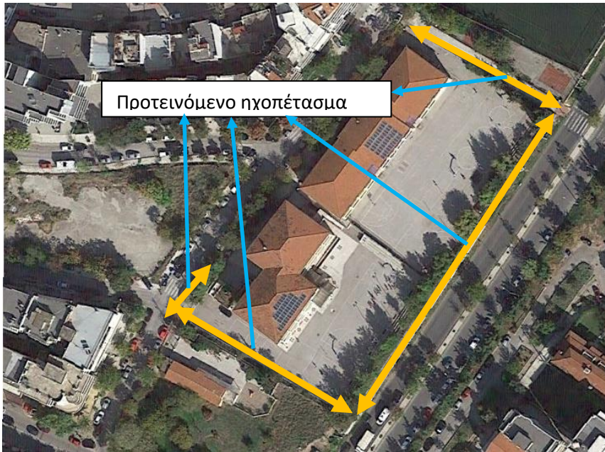
Σχήμα 21: Προτεινόμενο αντιθορυβικό πέτασμα στο σχολικό συγκρότημα επί της Έδισον 1 μήκους 260 μέτρων και ύψους 4 μέτρων
